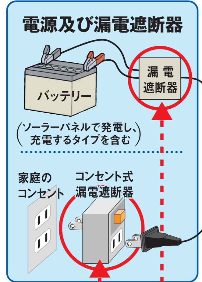
**漏電遮断器の設置**
